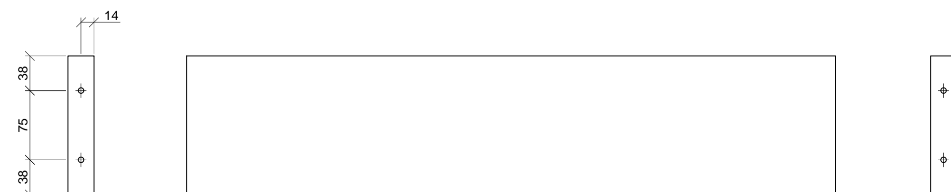
P2 B: CUATRO TABLAS QUE SE ATORNILLAN ENTRE LAS DOS LATERALES. TRES SE COLOCAN TUMBADAS Y UNA LEVANTADA, LA ÚLTIMA HACE DE REFUERZO.
